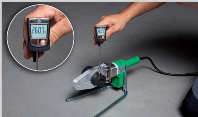
Измерение температуры на ручном сварочном аппарате aquatherm (800 Вт)
