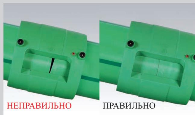
Для оптимального и стабильного соединения мы рекомендуем, чтобы оба края трубы внутри электромуфты прилегали друг к другу параллельно. Соблюдайте минимальную глубину сварки!
