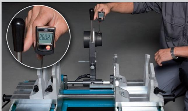
Измерение температуры на сварочной машине aquatherm
