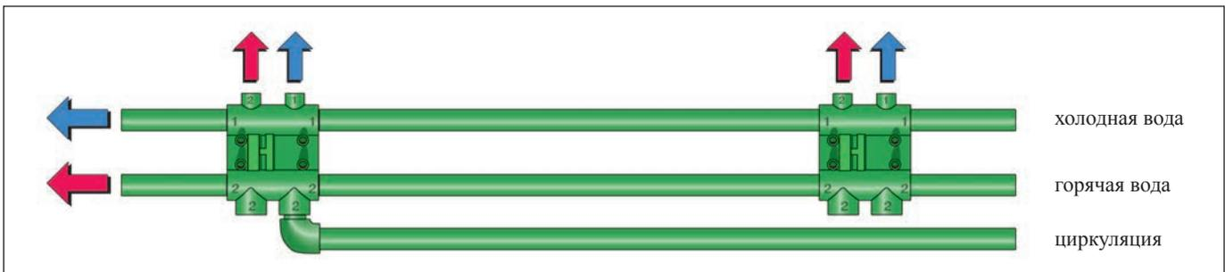
Соединительные трубопроводы на этажах или в стояках для холодного и горячего водоснабжения подключаются с помощью труб aquatherm PP-R или комбинированных труб aquatherm PP-R с наружным диаметром 25 мм. Аналогичным образом создают циркуляционные трубопроводы, которые могут быть отведены от любого распределительного блока aquatherm green pipe.
