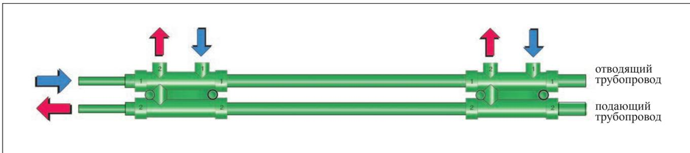
Подсоединение подающих и отводящих теплопроводов к распределительному блоку aquatherm производится при помощи труб aquatherm green pipe или aquatherm blue pipe с наружным диаметром 20 мм. Отводящие 16 мм патрубки в сочетании с соединительным коленом aquatherm (арт. № 85120) и крановым блоком (арт. № 85102 или 85106) делают возможным идеальное подключение радиатора отопления.
