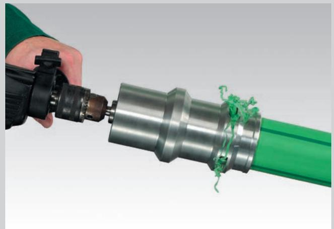
Зачистной инструмент aquatherm (арт. № 50558-50572, до 90 мм)
